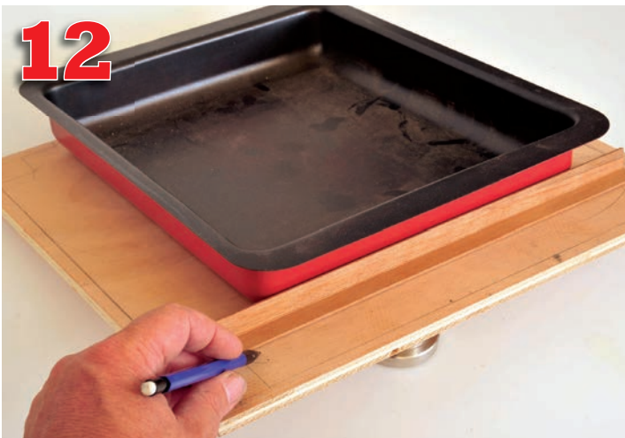
Placer le plat sur le fond de la boîte et se servir des cornières comme de glissières. Mesurer la longueur nécessaire en fonction de la dimension du plat.
