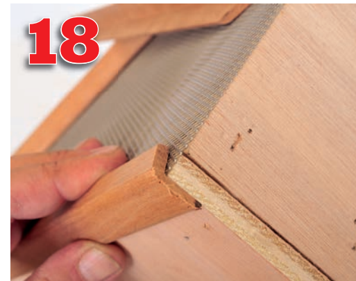
Recouvrir les bords avec les cornières prédécoupées avec un angle de 45°.
